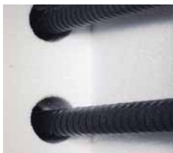
Ofenraum mit hochwertigem Fasermaterial und SiC-Heizstäben in beiden Seiten
