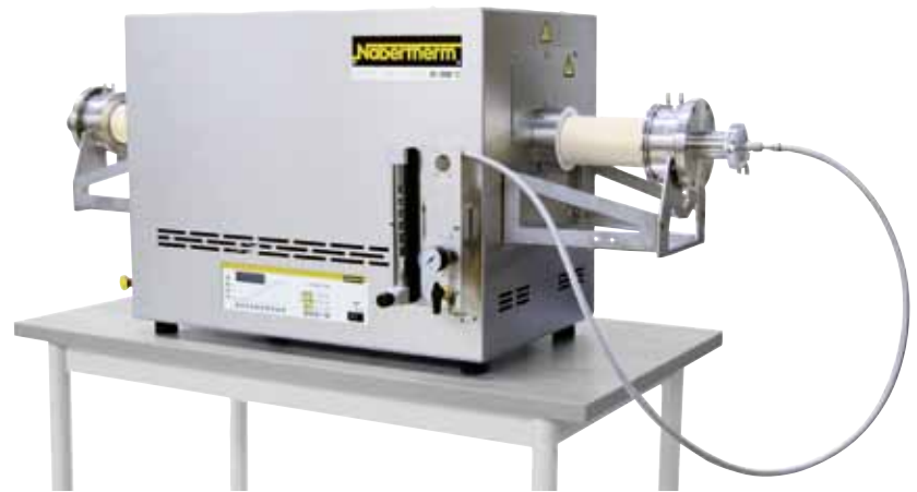
RHTC 80-450/15 mit manuellem Begasungssystem
