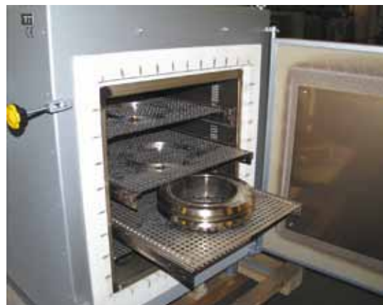
熱風循環炉室に装備された装入格子。テレスコーププレートでガイドされて個別に引き出し可能な装入格子
