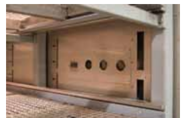
Traversées de raccords pour vide et mesure sur un four à chambre à convection d'air
