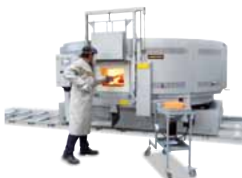
DH 2500/ S sur rails permettant un déplacement entre deux forges
