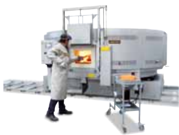
鍛造二工程間をレールで走行可能な DH 2500/ S
