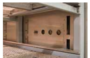
熱風循環式チャンバー炉に装備された真空・計測用結合部位
