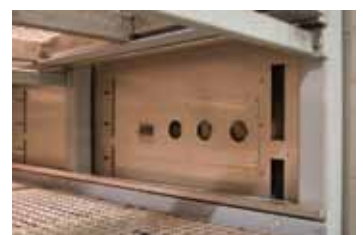
Conexiones para dispositivos de vacío y medición en un horno de cámara con aire circulante
