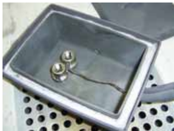
Soldadura fuerte en caja de recocido
