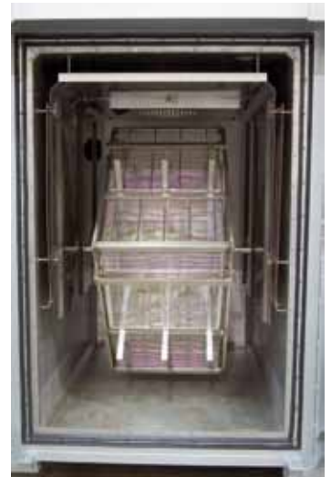
Horno de temple para silicona con cajón interior soldado y plataforma giratoria para la carga
