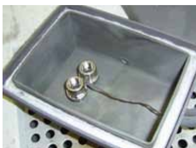
Soudobrasage dans caisson de mise sous gaz
