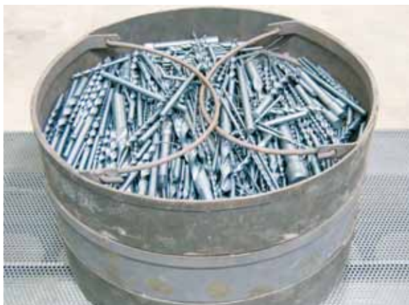
Bleuissement de forets à la vapeur dans un four de la série NRA voir page 12
