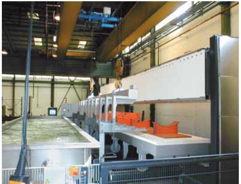
鋼棒材を硬化する手動型焼入れ・焼戻しプラント、62/63ページ参照
