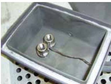
Soldadura fuerte en caja de recocido
