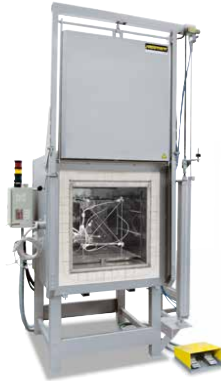
Συσκευή μέτρησης για την εξακρίβωση της θερμοκρασιακής ομοιομορφίας
