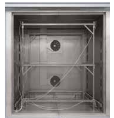
空気循環式チャンバー炉に装填可能な測定装置 N 7920/45 HAS
