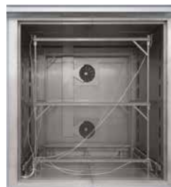
Estrutura de medição de encaixe para forno de câmara de circulação de ar N 7920/45 HAS
