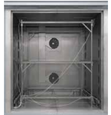
Hava dönüşümlü hazneli fırınlar N 7920/45 HAS için geçmeli ölçüm çerçevesi
