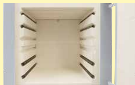
Zweiseitige Beheizung durch Heizelemente geschützt in Rillen
