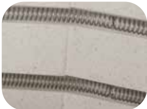
Heizelemente, geschützt in Rillen
