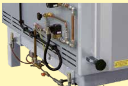
Gasstrecke und Thermoelement am Kammerofen
