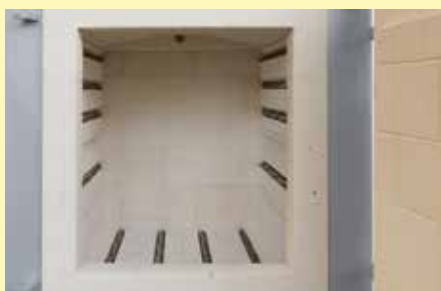
Dreiseitige Beheizung durch Heizelemente geschützt in Rillen
