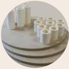
Brennhilfsmittelset bestehend aus Einbauplatten und Einbaustützen für eine Beschickung in mehreren Etagen
