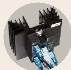
Geräuscharme Schaltung der Heizung über Halbleiterrelais
